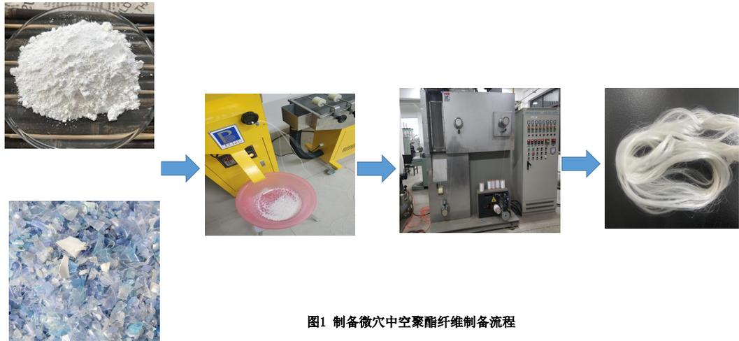
图1 制备微穴中空聚酯纤维制备流程
